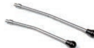
**Шаг 17.** Обратите внимание: рычаги управления раздаточной коробкой имеют разную длину. Рычаг включения переднего моста (фото сверху) имеет большую длину по сравнению с рычагом включения пониженного ряда (фото внизу). Установите рычаги на кронштейне возле крышки механизма переключения раздаточной коробки. Рычаг включения пониженного ряда устанавливается в левое отверстие и направлен вперед, рычаг включения переднего моста крепится в правом отверстии и направлен назад.
