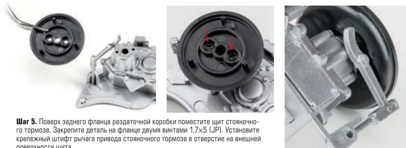
**Шаг 5.** Поверх заднего фланца раздаточной коробки поместите щит стояночного тормоза. Закрепите деталь на фланце двумя винтами 1,7×5 (JP). Установите крепежный штифт рычага привода стояночного тормоза в отверстие на внешней поверхности щита.
