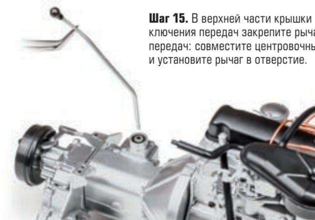
**Шаг 15.** В верхней части крышки механизма переключения передач закрепите рычаг переключения передач: совместите центровочные метки деталей и установите рычаг в отверстие.
