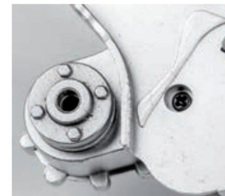
**Шаг 8.** В передней части корпуса раздаточной коробки установите передний фланец. Совместите крепежные штифты фланца с ответными отверстиями корпуса раздаточной коробки и плотно прижмите деталь к корпусу.
