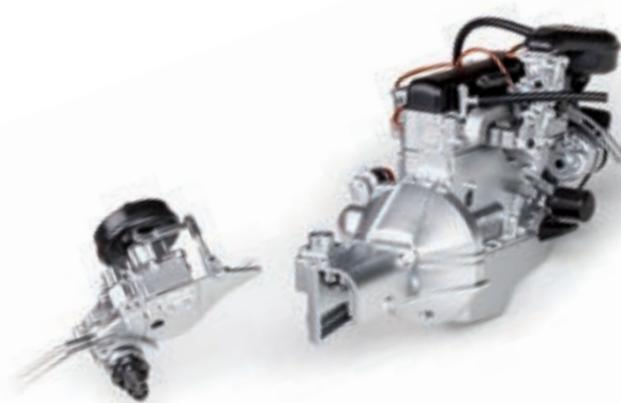
**Шаг 11.** Заднюю часть корпуса коробки передач состыкуйте с собранной ранее раздаточной коробкой. Закрепите раздаточную коробку двумя винтами 2,0×5 (IP) с внутренней стороны коробки передач.
