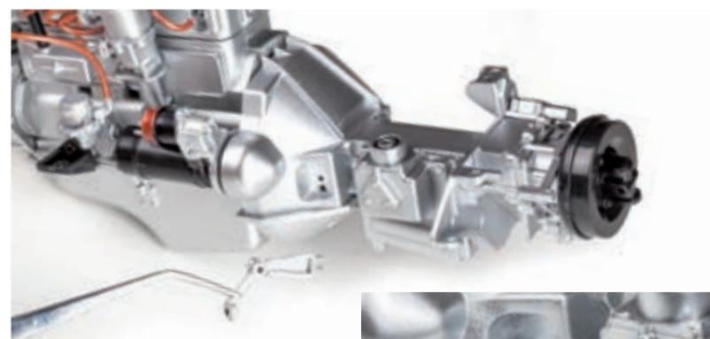
**Шаг 14.** Установите собранную вилку с левой стороны картера сцепления. Для исключения ошибки монтажа крепежные отверстия картера сцепления имеют разный диаметр, соответствующий диаметрам штырей вилок.
