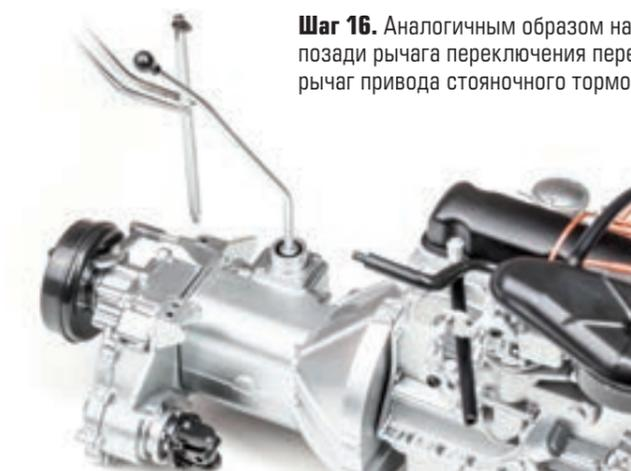
**Шаг 16.** Аналогичным образом на кронштейне, позади рычага переключения передач, установите рычаг привода стояночного тормоза.
